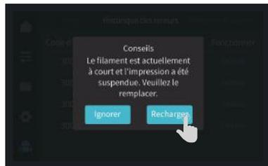
② En retournant à l'interface d'impression, réchauffez la buse pour atteindre la température d'extrusion.
