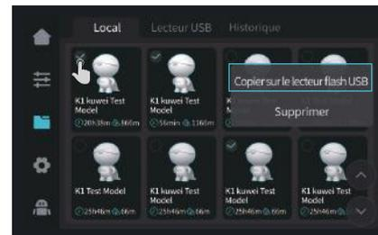
③ Appuyer et tenir sur le modèle pour le multi-sélectionner et le copier sur un disque flash USB.
